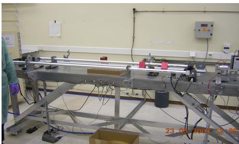
Κατασκευή θαλάμων μυνίων στο Πανεπιστήμιο Αθηνών
